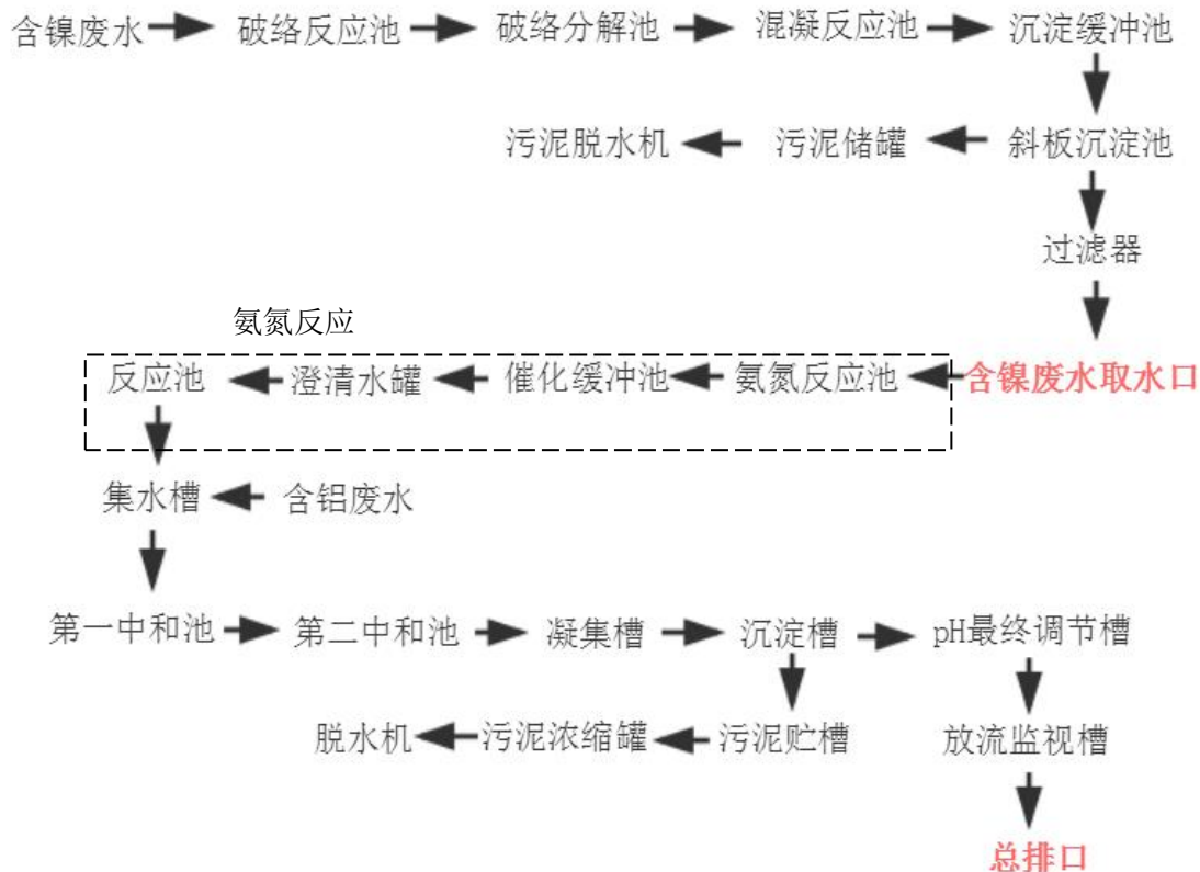
图 4-4 废水处理工艺流程
