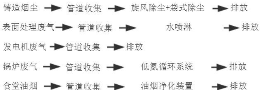
图 4-5 废气处理工艺流程
